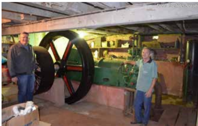
Máquina a vapor importada da Inglaterra para movimentar a serraria de Willy Eidt e geração de energia elétrica. Segundo o vice-prefeito de Tunápolis, eleito em 2016, Aquiles Bamberg (E), a máquina ainda funciona, inclusive a gás. Lauro Eidt (D) explica que o seu pai, Willy Eidt, adquiriu a máquina em Marau (RS) e, devido ao bom funcionamento, a empresa da família tornou-se uma potência regional na indústria madeireira em meados do século passado.
