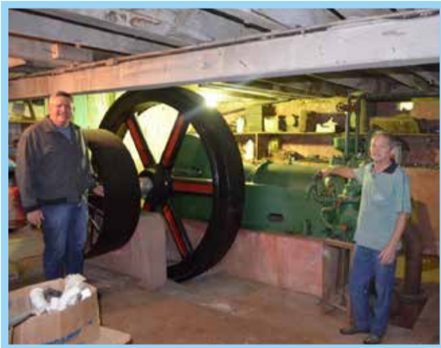
Máquina a vapor importada da Inglaterra para movimentar a serraria de Willy Eidt e geração de energia elétrica. Segundo o vice-prefeito de Tunápolis, eleito em 2016, Aquiles Bamberg (E), a máquina ainda funciona, inclusive a gás. Lauro Eidt (D) explica que o seu pai, Willy Eidt, adquiriu a máquina em Marau (RS) e, devido ao bom funcionamento, a empresa da família tornou-se uma potência regional na indústria madeireira em meados do século passado. (Foto: Euclides Staub)
