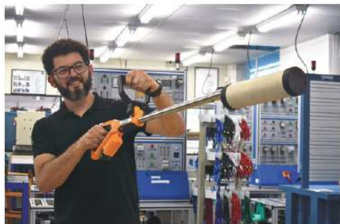
Modelo de enxada elimina plantas daninhas por descarga elétrica
